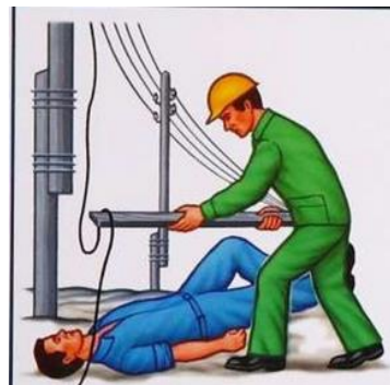
Іл. 16.2. Відкидання від потерпілого сухою дошкою або жердиною дроту, через який його ура-
