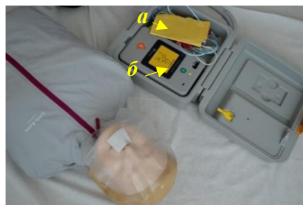
Іл. 8.3. Автоматичний зовнішній дефібрилятор (а — самоклеючі електроди; б — блок управління) вмикається автоматично з моменту відкриття кришки
